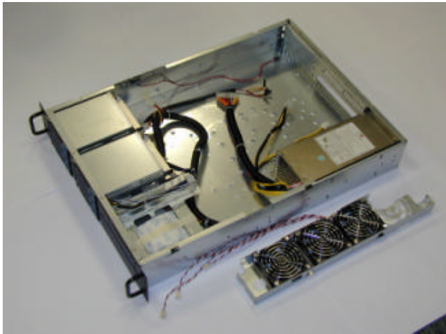
Step 4. Remove the fan bracket
